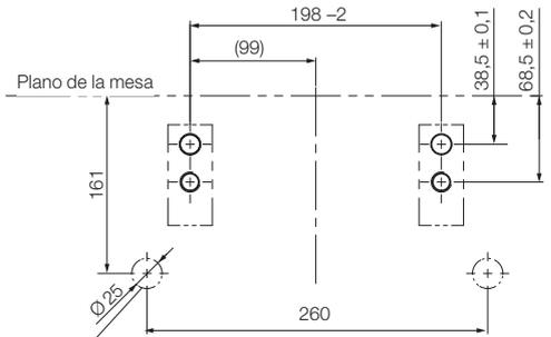
Posición de los puntos de apoyo (2x) de la mesa de cambio en la mesa de la máquina
