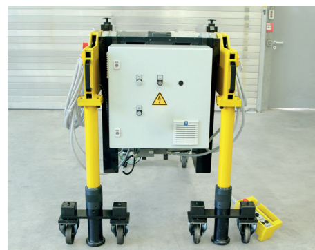
Opcjonalnie: sterowanie jest montowane bezpośrednio na konsoli; konsolę i sterowanie można całkowicie usunąć.
