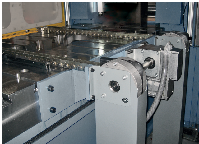
Konsola i system bezpośredniego prowadzenia łańcucha push-pull
