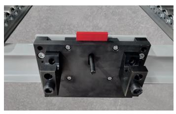
Crochet d'accostage semi-automatique et système de verrouillage de sécurité au système de rayonnage conçus pour les chariots pour changement d'outils RW / RWA 500
