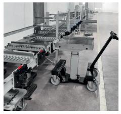
Système de rayonnage avec crochets d'accostage et chariot pour changement d'outils RW 500
