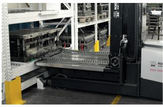
Système de rayonnage avec tasseaux d'accostage et chariot pour changement d'outils RWA 4000 avec chaîne de traction-poussée
