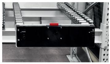
Crochet d'accostage semi-automatique et système de verrouillage de sécurité au système de rayonnage, conçus pour les chariots pour changement d'outils RW / RWA 1000
