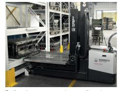
Système de rayonnage avec tasseaux d'accostage et chariot pour changement d'outils RWA 4000 avec chaîne de traction-poussée
