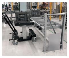
Accostage semi-automatique d'un chariot pour changement d'outils RW 500 et système de rayonnage
