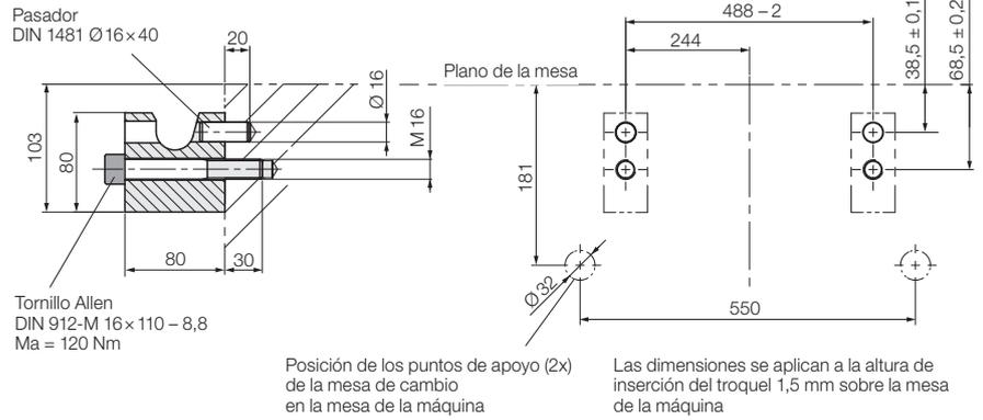
**Placa adaptadora con ganchos de acoplamiento**
