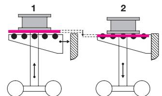
Ejecución del carro de cambio sin puente con estación de acoplamiento de seguridad y mesa de bolas
