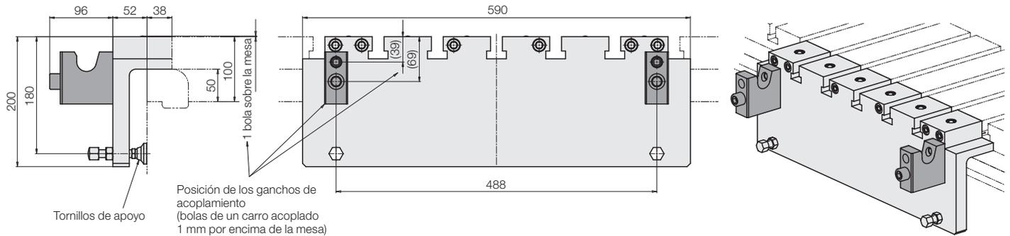
**Listones de acoplamiento para el carro con puente**
