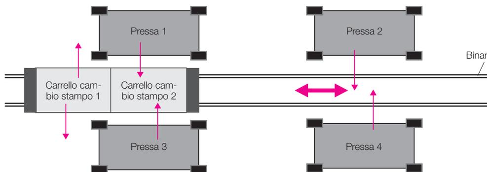
**Concetto 4** Carrello per cambio singolo con asse di trasferimento ruotato
