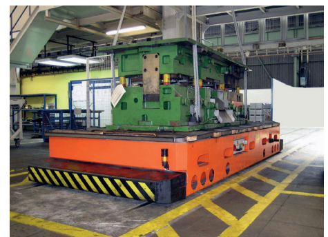
Chariot de transport, déplaçable sur rails
