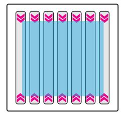
Les lignes de champs magnétiques des surfaces de pôles non recouvertes agissent sur le moule et permettent ainsi un serrage sûr des plus petits moules.
