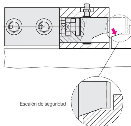
La presión hidráulica debe permanecer asegurada por motivos de seguridad en el sentido de las directivas de maquinaria ML 2006 / 42 / CE. Los troqueles o moldes superiores que estén sujetos mediante elementos de sujeción en forma de cuña, se deben asegurar mecánicamente durante los trabajos de mantenimiento.
