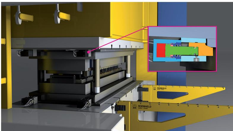
Elementos de sujeción en forma de cuña con escalón de seguridad en la mesa superior
