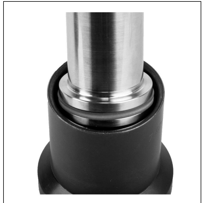
Fig. 8 : Calibrage d'un joint d'étanchéité extérieur avec aide
