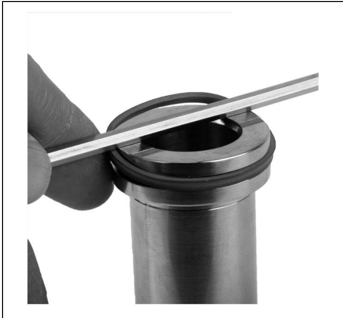
Fig. 7 : Montage dans une rainure fermée, sans aide
